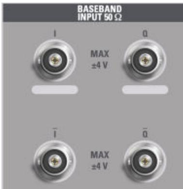
Os conectores BNC superiores, BASEBAND INPUT I e BASEBAND INPUT Q são utilizados para induzir sinais de terminação única, o sinal de entrada positiva para sinais diferenciais, bem como uma entrada para **sondas activas da Rohde & Schwarz** (R&S RT-ZSxx e sondas diferenciais RT-ZDxx).
